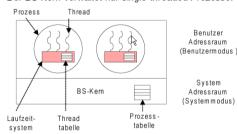
Threads werden durch Laufzeitsystem im Benutzeradressraum verwaltet. Eine Thread-Tabelle speichert Informationen (Register, Zustand, etc.) über Threads pro Prozess.
